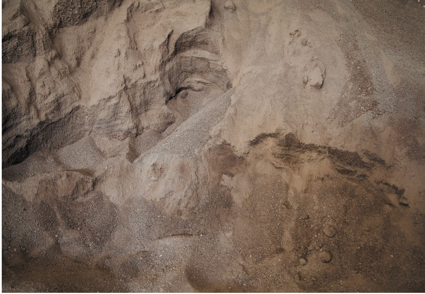
▼ Matière première pour les produits en terre crue : terres issues de déblais d'excavation de chantier, photographie : Barbara Haemmig-de Preux.
