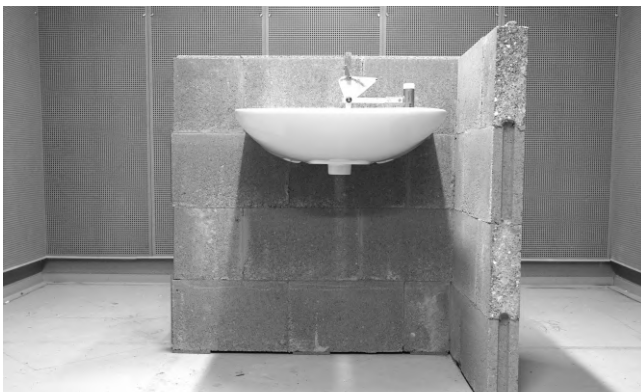
Salle semi-anéchoïque avec échantillon de mur
