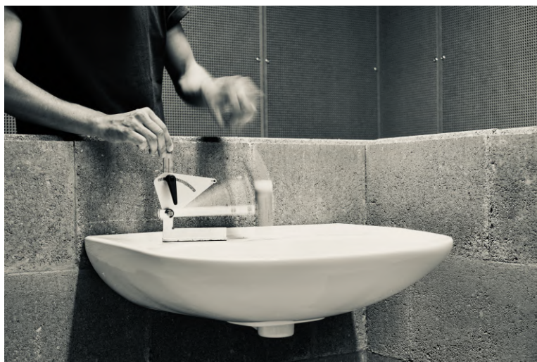
Figure 4 : Photo du principe de mesure à l'aide du marteau normalisé EMPA
