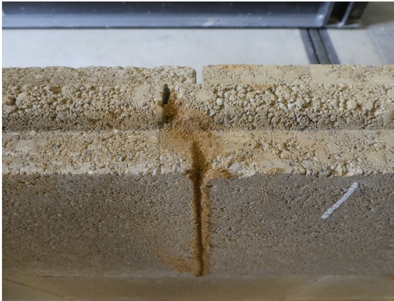
Illustration 4: Joint entre deux éléments
