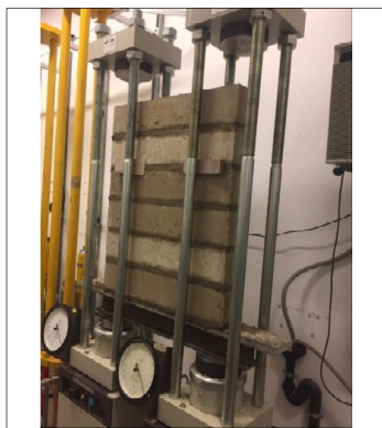
Mise en place de mur sous le système de charge
