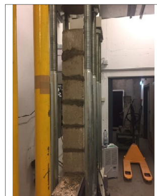
Vue latérale avant la mise en charge
