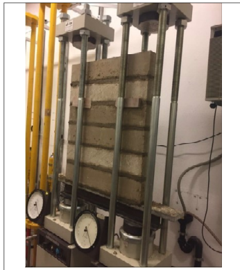
Anbringen der Wand unter dem Ladesystem
