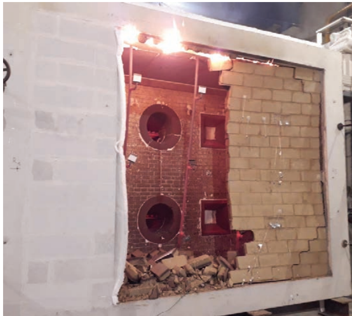
→ Mesure de EI réalisée au CERIB sur un mur en BTC Cycle Terre de 9,5 cm d'épaisseur : avant et après 50 minutes d'exposition au feu
