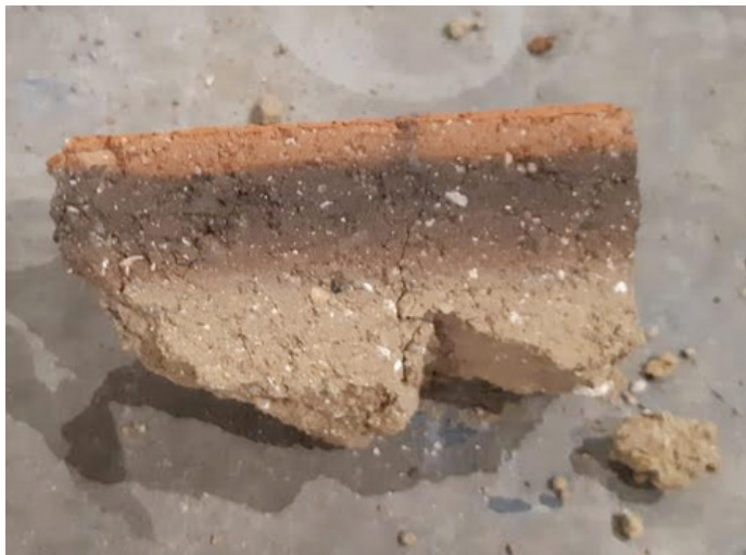
→ BTC après essai au feu
