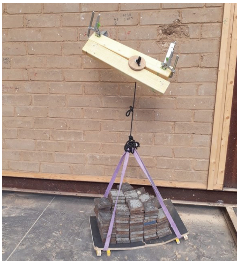
Essai de suspension d'objets lourds en charge excentrée réalisé sur un mur en BTC Cycle Terre
