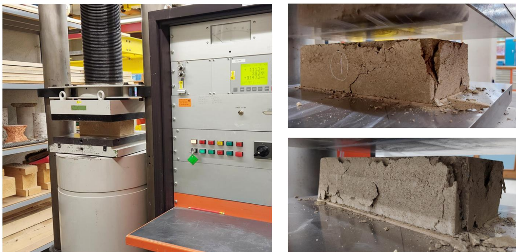
Figure 9: Essai de compression sur BTC - Dispositif expérimental
