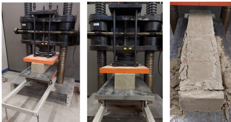
Figure 8: Essai de compression sur Terrapads - Dispositif expérimental
