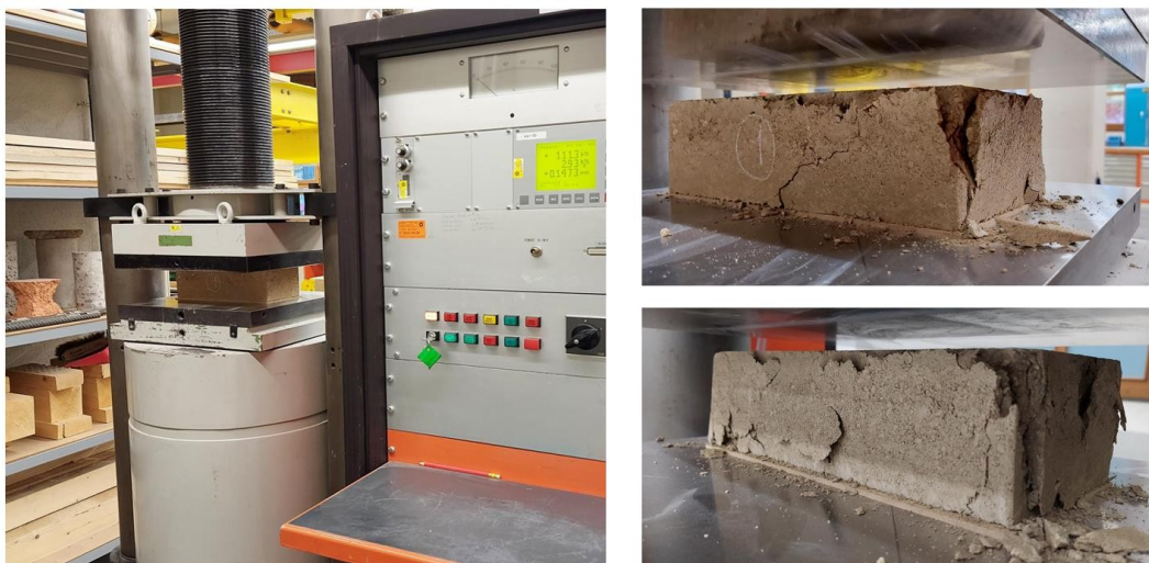
Abbildung 9: Druckversuch an BTC - Versuchsaufbau
