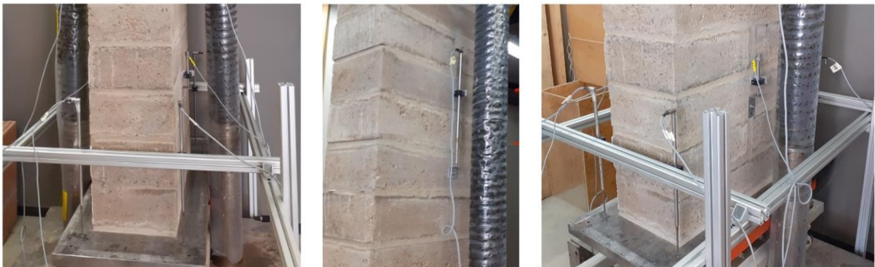
Abbildung 10: Instrumentierung der Wand
