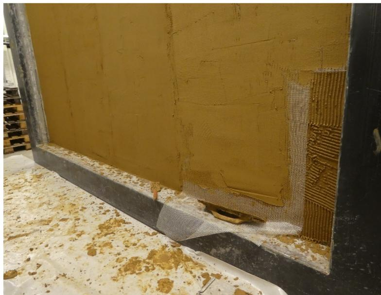
Abbildung 9: 5 mm Lehmputzschicht mit Netzschicht
