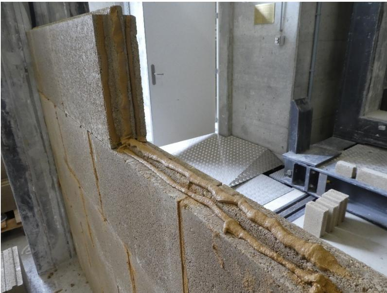
Abbildung 3: Aufbau der TERRAPLAC Wand mit Lehmklebemörtel
