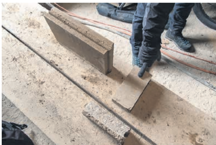
Les terraplacs sont faits essentiellement de terre crue, issue de déblais de chantiers, et de billes d'argile expansées.
