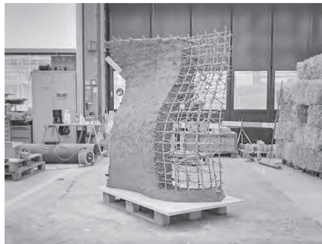
Das ETH-Spin-off Oxara entwickelt einen giessbaren Lehm. | La spin-off Oxara de l'EPFZ développe une terre argileuse qui peut être moulée. Foto | Photo: Oxara
