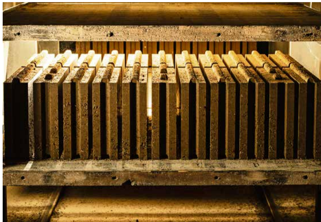
Les Terraplac ne sont épais que de 8 cm et sont 25% plus légers que les premiers produits de la société, les briques Terrabloc. Celles-ci ont commencé à bâtir la réputation de l'entreprise et ont été suivies par des éléments plus volumineux, les Terrapad.
