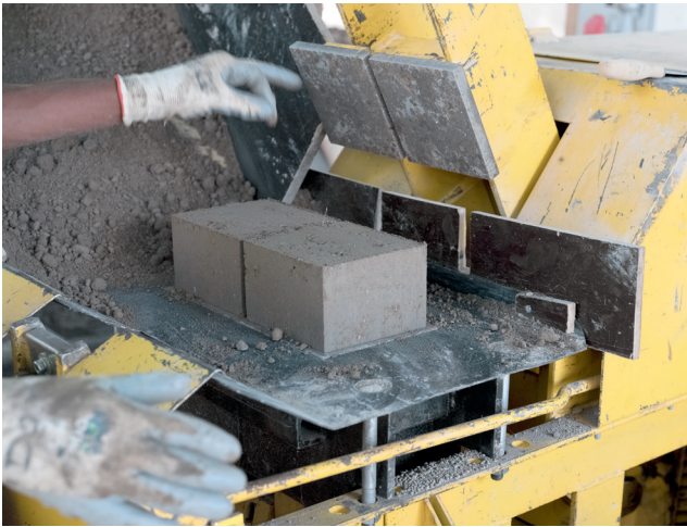
Fünf Arbeiter haben an der mobilen Presse die lose Erde in harte Ziegel verwandelt. Im Rahmen des Architekturvermittlungsprogramms «Chantier ouvert» haben an einigen Tagen auch Schulkinder Hand angelegt.
