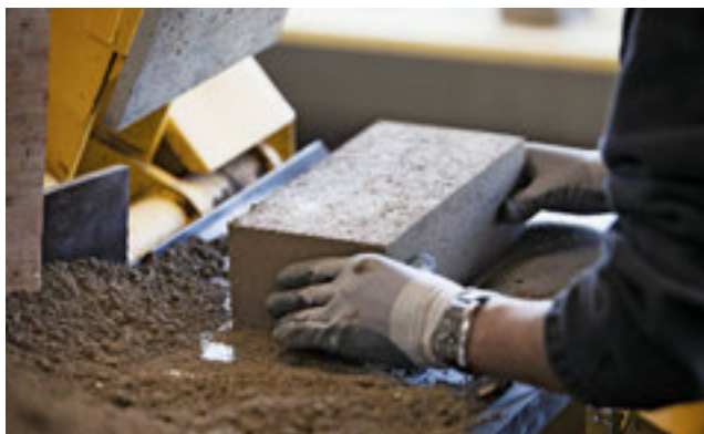
Mit einer Presse werden die Steine in die exakte Form gebracht.
