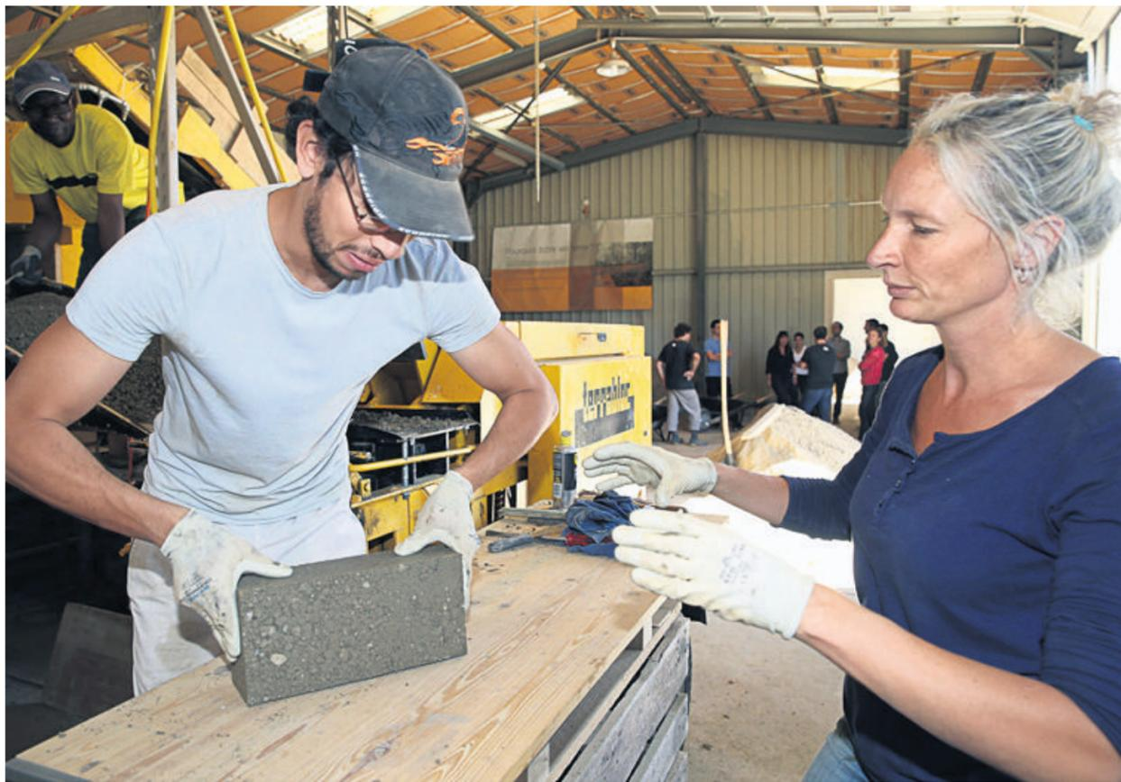
La fabrication des blocs de terre compressée se fait une à une dans l'usine de Gland. OLIVIER ALLENSPACH
