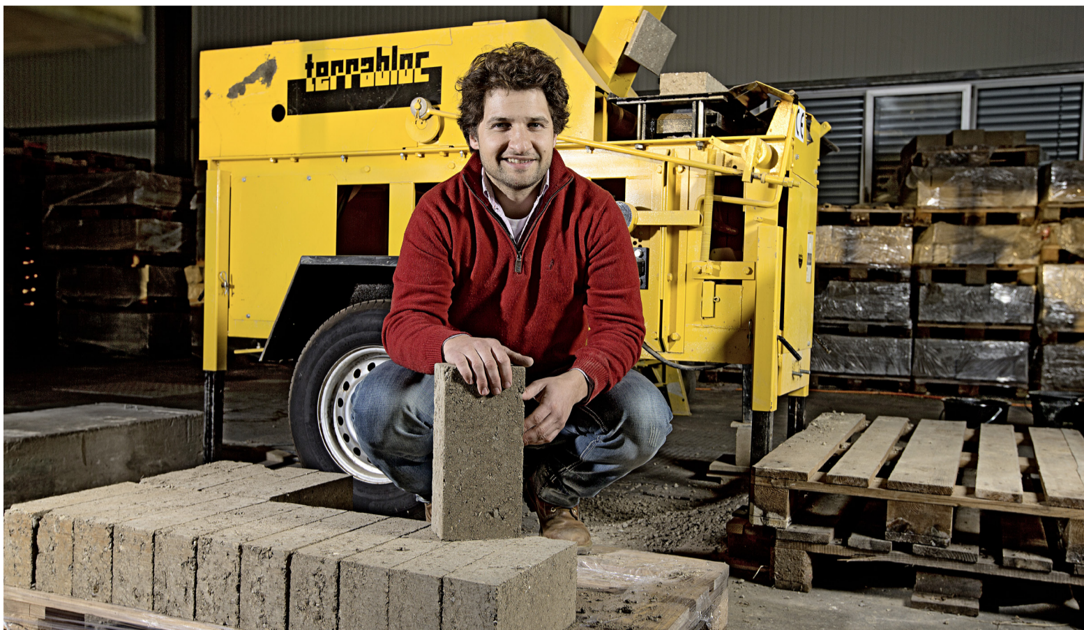
Cofondateur Terrabloc, Rodrigo Fernandez présente un modèle de brique fabriquée à partir de matériaux d'excavation qui, d'ordinaire, finissent trop souvent dans des décharges. Après des essais concluants, l'entreprise envisage de poursuivre son développement.
