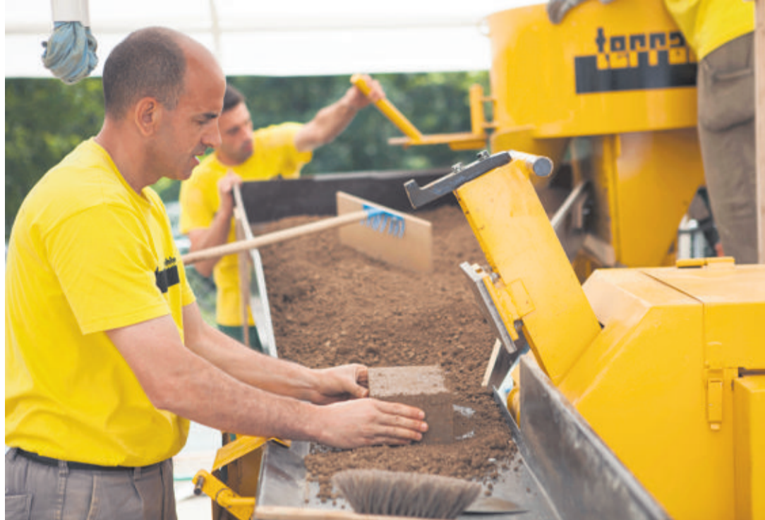
La terre est tamisée, séchée, puis malaxée, humectée et pressée, avant de reposer pendant vingt-huit jours. Ci-dessus: Laurent de Wurstemberger, architecte, et Rodrigo Fernandez, ingénieur. P. ALBOUY
